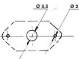
Pour déterminer la position dans laquelle placer les roues de halage sur le miroir de poupe, veuillez appliquer cet adhésif dans la position indiquée dans les instructions et faire des points indiqués.
