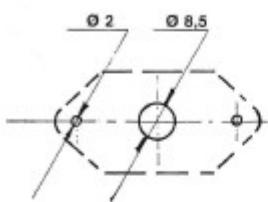
Per determinare la posizione in cui sistemare le ruote di allaggio sulla superficie della poppa, applicare questo adesivo nella posizione indicata nelle istruzioni e provvedere a forare nei punti contrassegnati.
