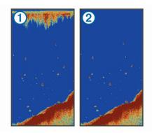
Le bruit de surface ① est causé par une interférence entre la sonde et l'eau. Vous pouvez masquer le bruit de surface ② pour atténuer les parasites. Les largeurs de faisceau plus importantes (fréquences plus basses) peuvent afficher plus de cibles mais générer plus de bruit de surface.
