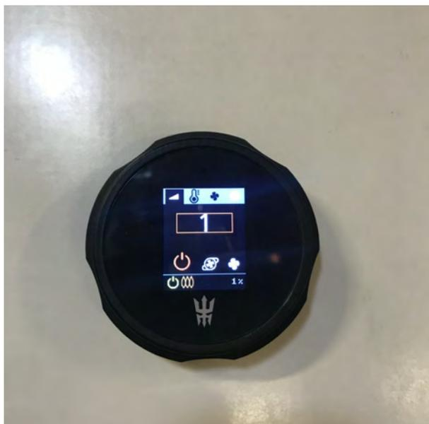
Die Heizung wird abgeschaltet durch Drehen des Drehrades und längeres gedrückt halten des Knopfes bei entsprechender Auswahl.
