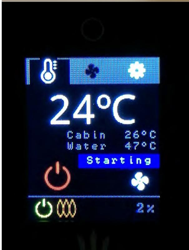
Bei der Zündung des Brenners leuchtet die Flammanzeige auf
