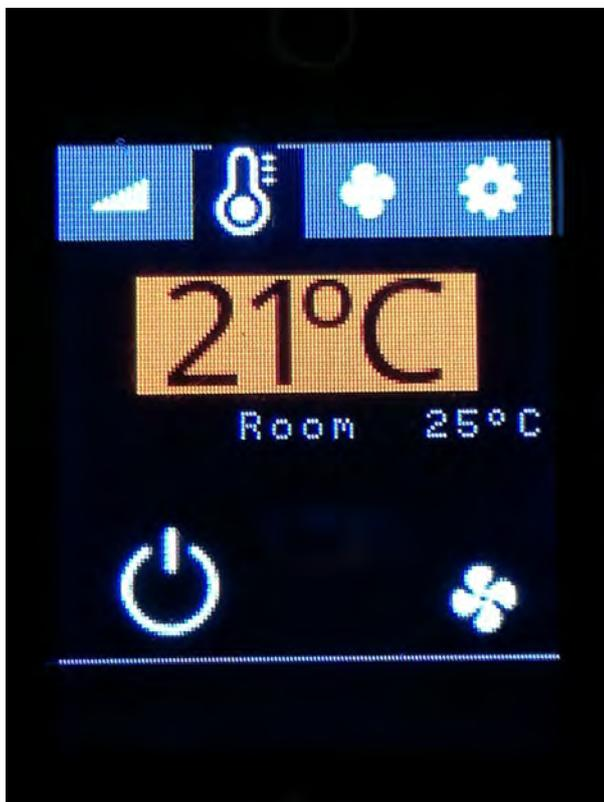
Einschalten der zusätzlichen Wasserpumpe. Diese Funktion steuert das Relais auf der Elektronikplatine der Heizung und steuert den Einsatz einer zusätzlichen Wasserpumpe z. B. zur Warmwassergewinnung für das Trinkwassernetz, beheizte Sitze o.ä.
