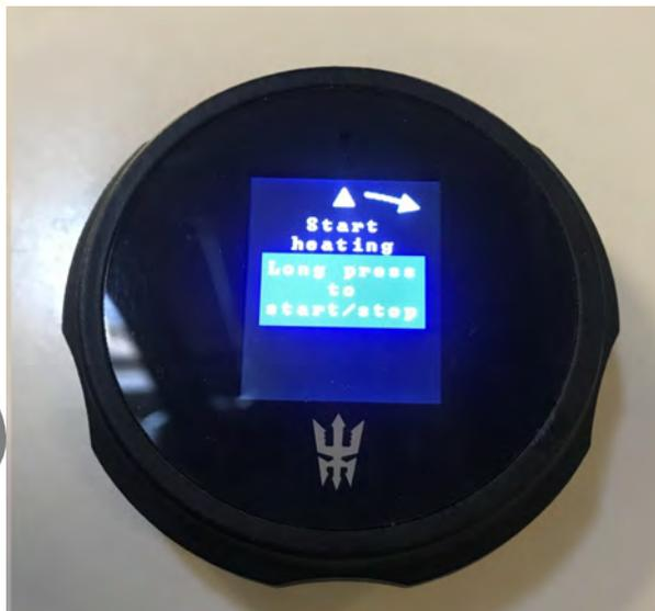
Wählen Sie die gewünschte Temperatur durch Drehen des Auswahl-Rings und bestätigen Sie diese durch drücken des Knopfes.
