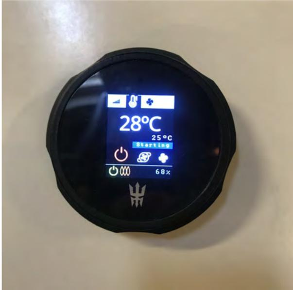
Wenn das Startprotokoll abgeschlossen ist, erlischt die Modus Anzeige "Start". Die ausgewählte Funktion ist hervorgehoben. Wenn etwas eingestellt werden muss, wählen Sie die gewünschte Funktion durch Drehen des Auswahl-Ringes aus und bestätigen die Änderung durch drücken des Druckknopfes.
