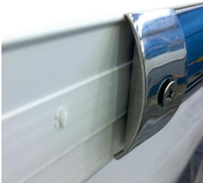
Será necesario tener cuidado que el mandril del taladro no toque el hueco del tornillo, así aconsejamos introducir encima de la punta un tampón de fiel corsa de plástico o aluminio, esta fácil operación evitará mellar el inox con el material hierroso del mandril. Se aconseja poner silicona sobre el agujero y también sellar, así renderá l'avvitamento più morbido.
