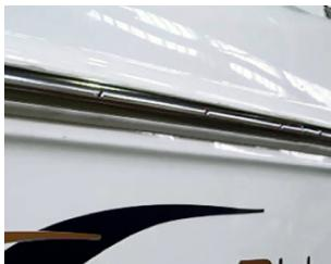
Um die Edelstahlleisten zu fixieren empfehlen wir, dass Sie vom Bug her anfangen, einen Barren (Leiste) in der Mitte leicht vorbiegen, damit es an Bord selber so rechts und links dieselben Längen ergeben.
