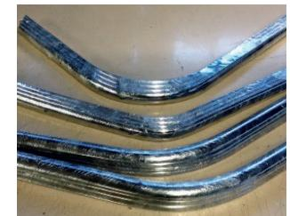
Les courbes horizontales avec un rayon de plus de 40 cm pourraient être faites directement sur le bateau en vissant et en pliant à chaque fois jusqu'à terminer la courbe; le bateau même aura la fonction de gabarit et de ligne directrice.
