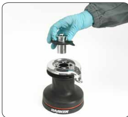
2. Wsuń gniazdo korby n°20 oraz pokrywę n°19
