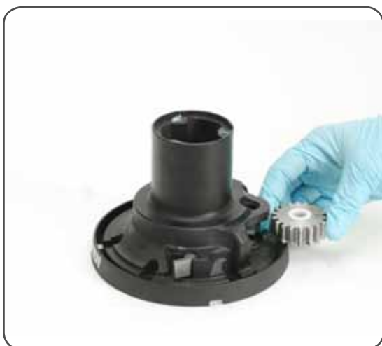
10. Wysuń zębatkę n°3 i wyjmij tuleję
