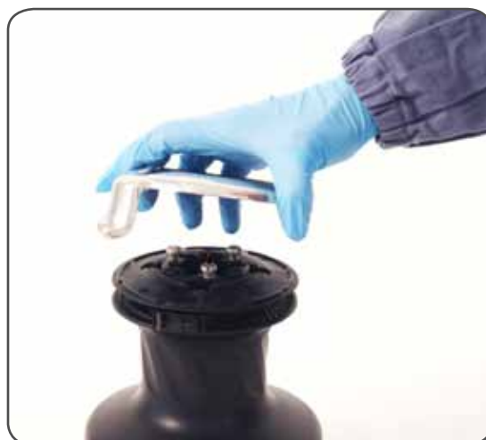
4. Obróć i zdejmij ramię układu samoknagowania n°18
