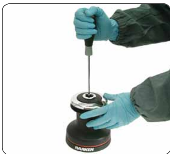
1. Odkręć śrubę główną (🔧 2Nm/18 in-lb)
