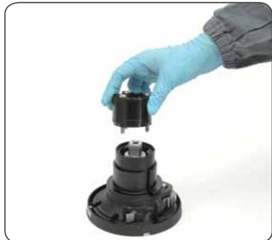
7. Zdejmij podstawę ramienia układu samoknagowania n°12
