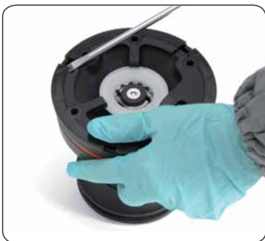
1. Za pomocą śrubokręta poluzuj kołnierz n°2
