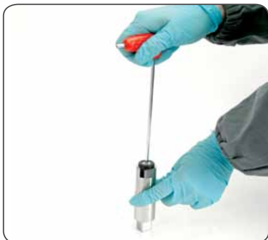
Odkręć śrubę n°10 i wyjmij podkładkę n°9 (4Nm/35 in-lb)
