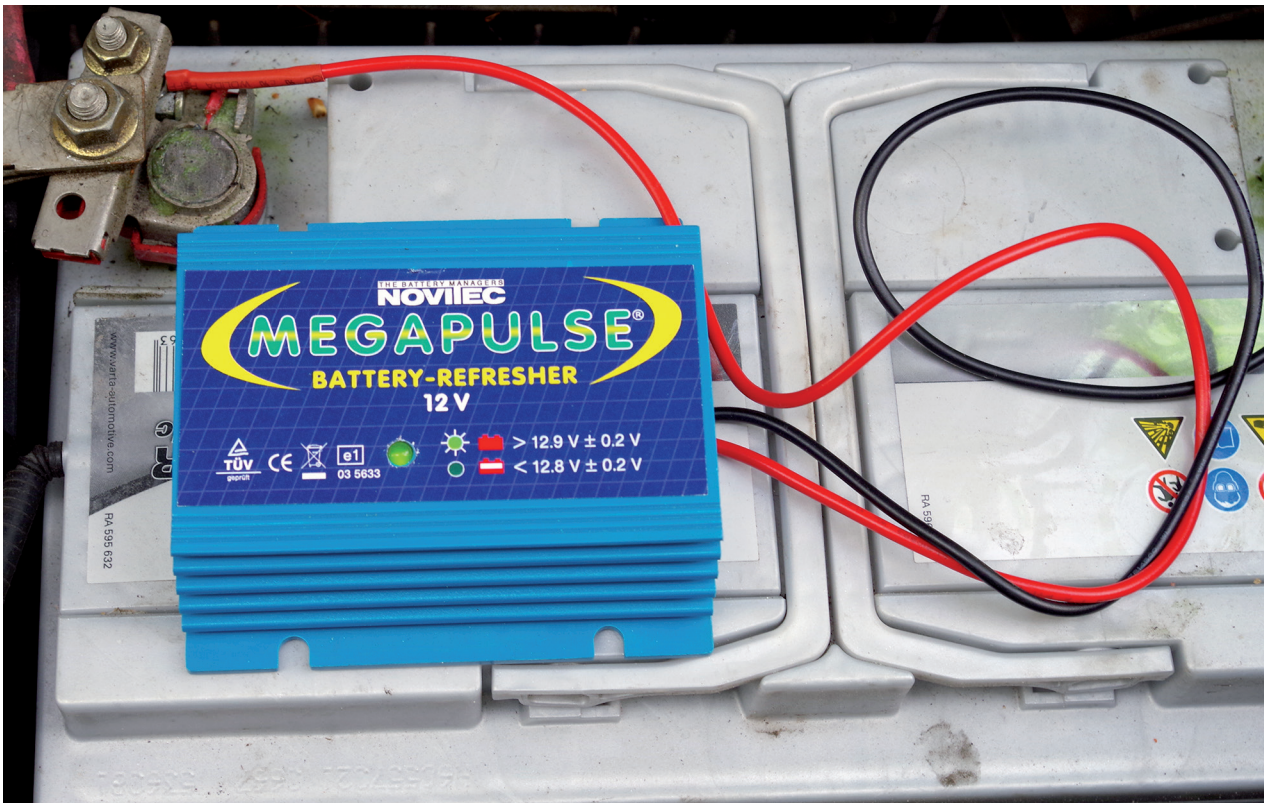
Der Megapulse holt sich seine Betriebsspannung aus der zu pulsenden Batterie.
