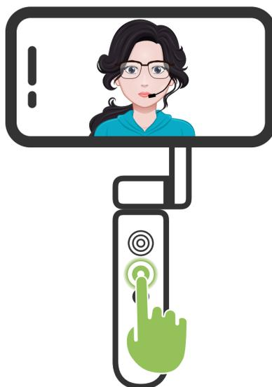
Um die Verfolgung zu beenden, justieren Sie die Richtungstasten oder betätigen Sie die 5-Wege-Taste während des Verfolgungsvorgangs zweimal.
