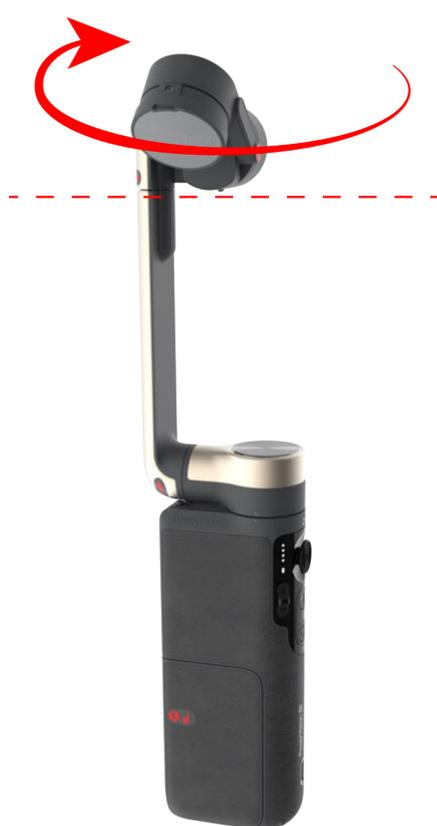
Halten Sie den Hauptarm und drehen Sie das [Kippgelenk] im Uhrzeigersinn in die abgebildete Position.
