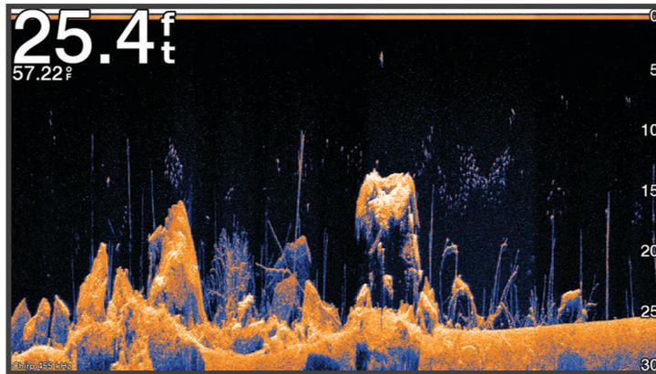
Los transductores tradicionales emiten un haz cónico. La tecnología de la sonda de exploración Garmin ClearVü emite un haz similar a la forma del haz de una fotocopiadora. Este haz ofrece una imagen más clara, similar a una fotografía, de lo que hay debajo de la embarcación.
