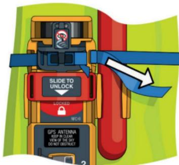
11. Sobald das PLB3 vollständig an der Schwimmweste befestigt ist, können Sie das Gerät scharfschalten, indem Sie die rote Scharfschaltlasche nach unten schieben.
