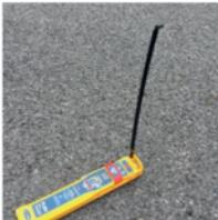
Wenn Sie an Land bleiben, stellen Sie sicher, dass die Antenne vertikal ist und der Bereich markiert ist „NICHT BEHINDERN“ unter dem roten Scharfschaltchieber bei freier Sicht zum Himmel.
