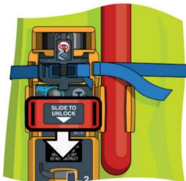
12. Eine Schutzabdeckung schützt das PLB3 vor versehentlicher Aktivierung, wenn der graue Schieber angestoßen oder auf andere Weise unter der Schwimmwestenabdeckung bewegt wird. Bringen Sie nach dem Scharfschalten des PLB3 die Schutzabdeckung an und klemmen Sie die Schutzabdeckung dann in die Schlitzle unmittelbar neben dem Scharfschaltchieber ein. Stellen Sie sicher, dass beide Seiten der Abdeckung eingerastet sind.
