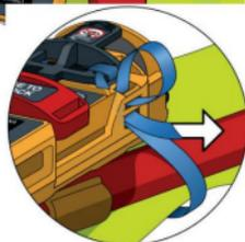
7. Ziehen Sie ca. 25 mm (1 Zoll) Klebeband durch die Schlitz im PLB3
