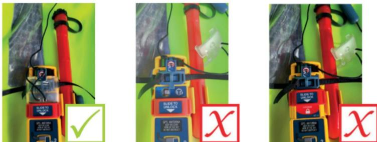
In den obigen Diagrammen wird davon ausgegangen, dass sich der Aufblaschlauch der Schwimmweste auf der linken Seite der Weste befindet (von vorne gesehen).
