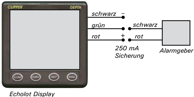
Abbildung: Anschlußübersicht Alarmgeber
