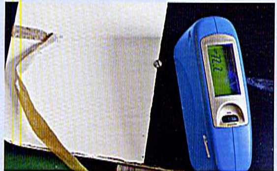
Der blaue Glossmeter wird auf die Fläche gestellt und misst dort im Bruchteil einer Sekunde
