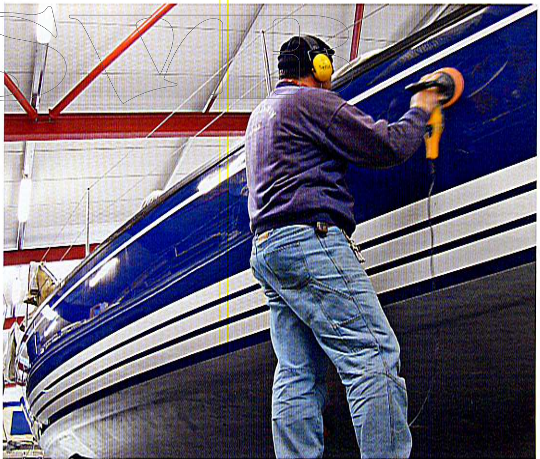
Wird die Poliermaschine kreuz und quer über den Bootsrumph geführt, entstehen die besten Ergebnisse
